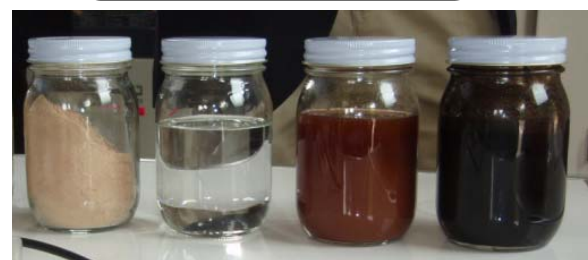
(左から) 原料 (オガコ)、溶媒、原料 (投入時)、バイオオイル
