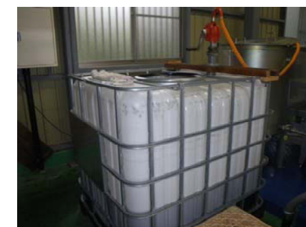
①原料貯蔵（原料貯槽） 1m 3 の原料貯槽で原料を貯蔵し均一化します。
