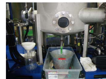
③反応・静置グリセリン分離 前処理後の廃食油にメタノールと触媒を加え反応させます。 反応終了後、副生するグリセリンを比重差により沈降させ分離除去します。
